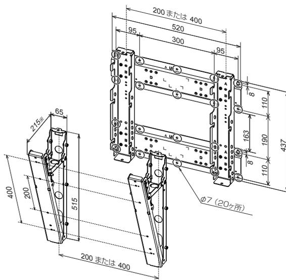
○印のねじ孔(20ヶ所)を、市販のねじ(径6mm)で固定します。
